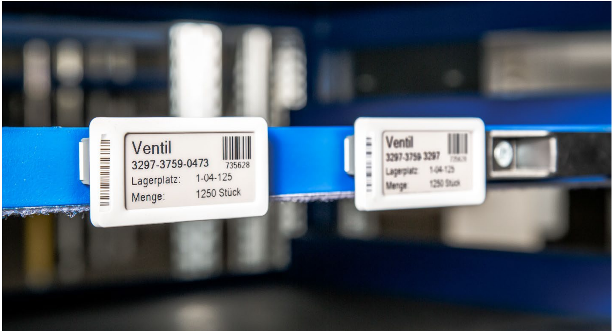
Abbildung 3: E-labels als Lagerplatzkennzeichnung
