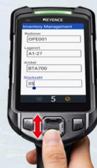
\* Dieser Codeleser kann Codes in einem Mindestabstand von 2,5 cm bei Barcodes mit der kleinsten Strichbreite von 0,5 mm und in einem Maximalabstand von 10 m bei Barcodes mit der kleinsten Strichbreite von 1,5 mm scannen.
