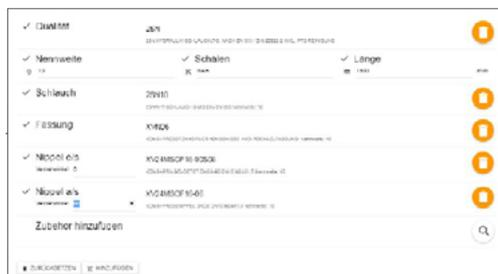
Le cœur de l'application HSR, c'est le configurateur de tuyaux. Ce système permet de configurer exactement le flexible hydraulique adapté, avec les bons raccords, pour un ordre de service sur site chez le client.
