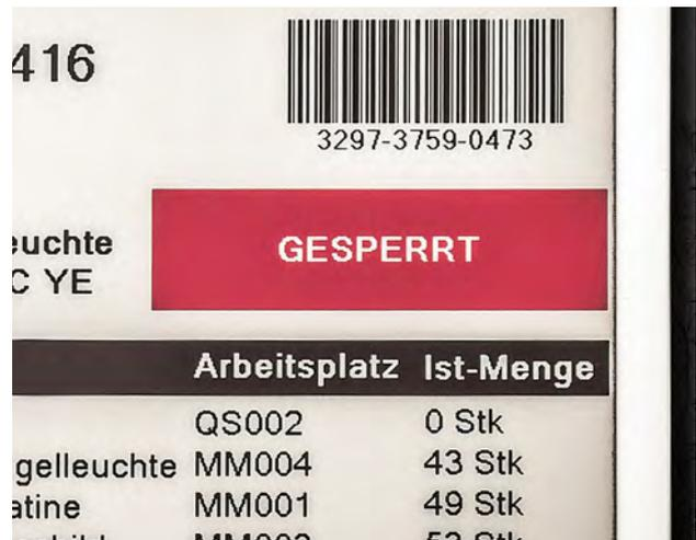
Befindet sich ein Auftrag im Sperrstatus, wird dies auf den e-label anstelle der Auftragsdetails deutlich dargestellt.
